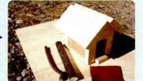
5. 초립된 모습. 220방 다소 거친 사포로 새집의 입구와 모서리를 매끈하게 다듬어 준다. 도색전 다시 600방 고운 사포로 전체를 문질러 준다.
